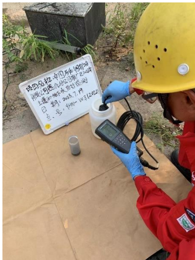
YHN-W3-水质现场快速检测 (7月采样)
