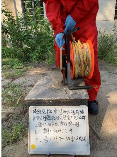
YHN-W3-洗井前测量水位 (7月采样)
