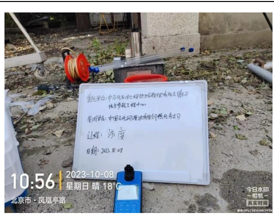
YHN-W1-浊度现场快速检测（10月采样）
