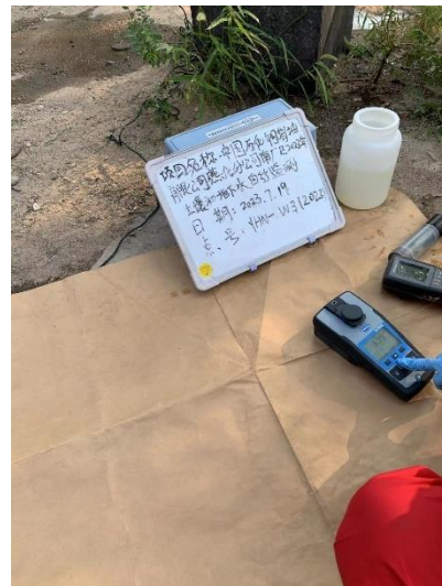
YHN-W3-浊度现场快速检测 (7月采样)
